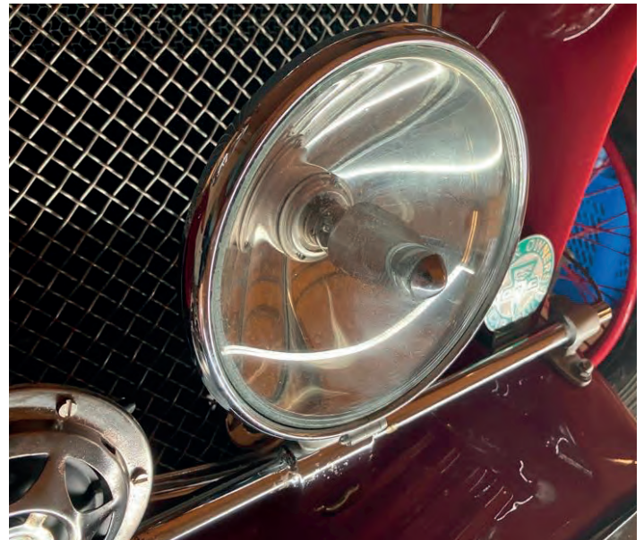
Midtre frontlykt der glasset altså kommer fra et grytelokk.
