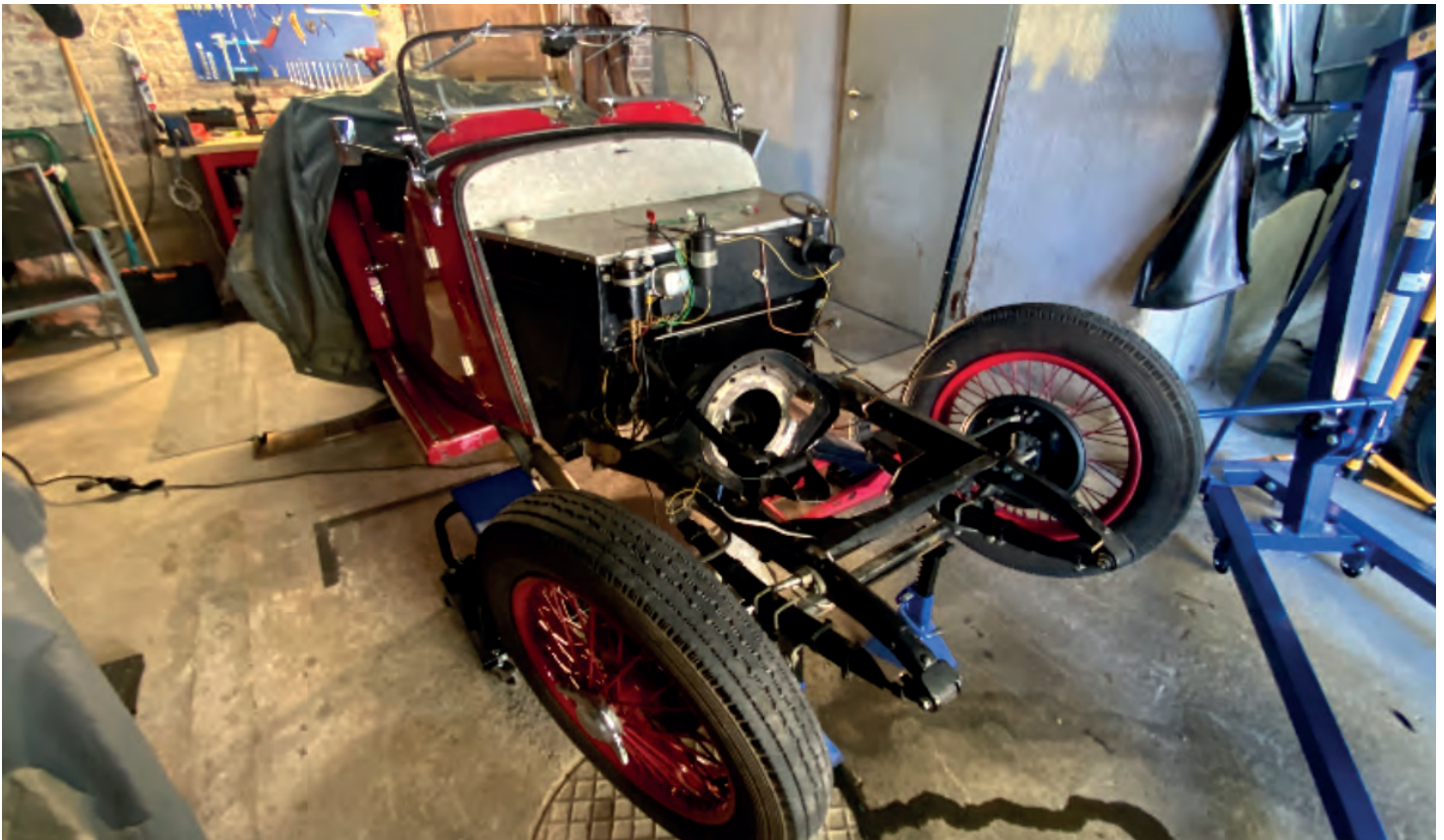
Et nyere foto fra bytte av motor og girkasse.
